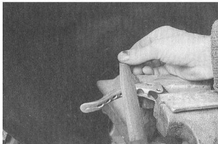
5 Der quer eingespannte Hebel wird nun auch an den Seiten flachgefeilt
